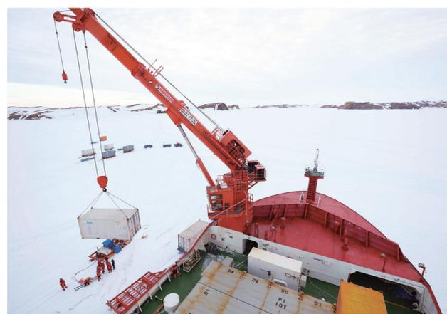
“雪龙2”号的吊机在卸货(12月9日摄)。日前,执行中国第41次南极考察任务的“雪龙”号和“雪龙2”号开始南极中山站区域卸货作业。中山站位于南极普里兹湾的拉斯曼丘陵。从科考船向中山站运送物资,需要一路破冰并尽可能接近中山站,再通过雪地车或直升机卸货。由于海冰情况复杂,“雪龙2”号短时间内无法将“雪龙”号引航至预定作业点。为保障后续任务顺利推进,考察队首次尝试将“雪龙2”号作为“摆渡船”,并成功为“雪龙”号转运部分重型物资到中山站附近的海冰卸货点,再用雪地车将物资送至中山站。“雪龙”号上其余物资直接由直升机运送上站。
