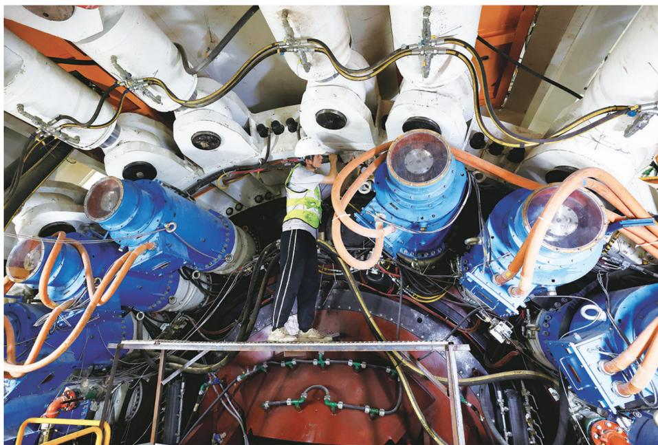
5月14日,施工人员在检查“龙岗3号”盾构机主驱动电机。
