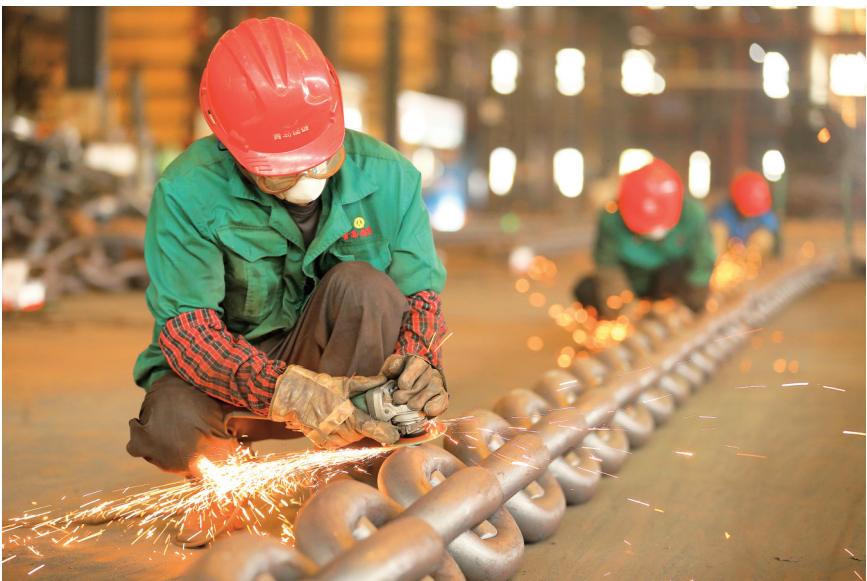
8月25日,青岛锚链股份有限公司工人在生产出口到海外市场的锚链产品。 连日来,在位于山东省青岛市即墨区灵山街道的即墨区锚链产业园生产车间,工人加班加点赶制出口到海外市场的“订单锚链”产品,满足客户需求。 今年以来,即墨区锚链生产企业加快科技创新步伐,提升自主品牌竞争力,积极拓展海外市场,迎来产销两旺的良好态势。目前,企业生产的船用锚链、海洋工程系泊链及附件产品出口到欧美、日韩、东南亚等30多个国家和地区。 【新华社发(梁孝鹏 摄)】
