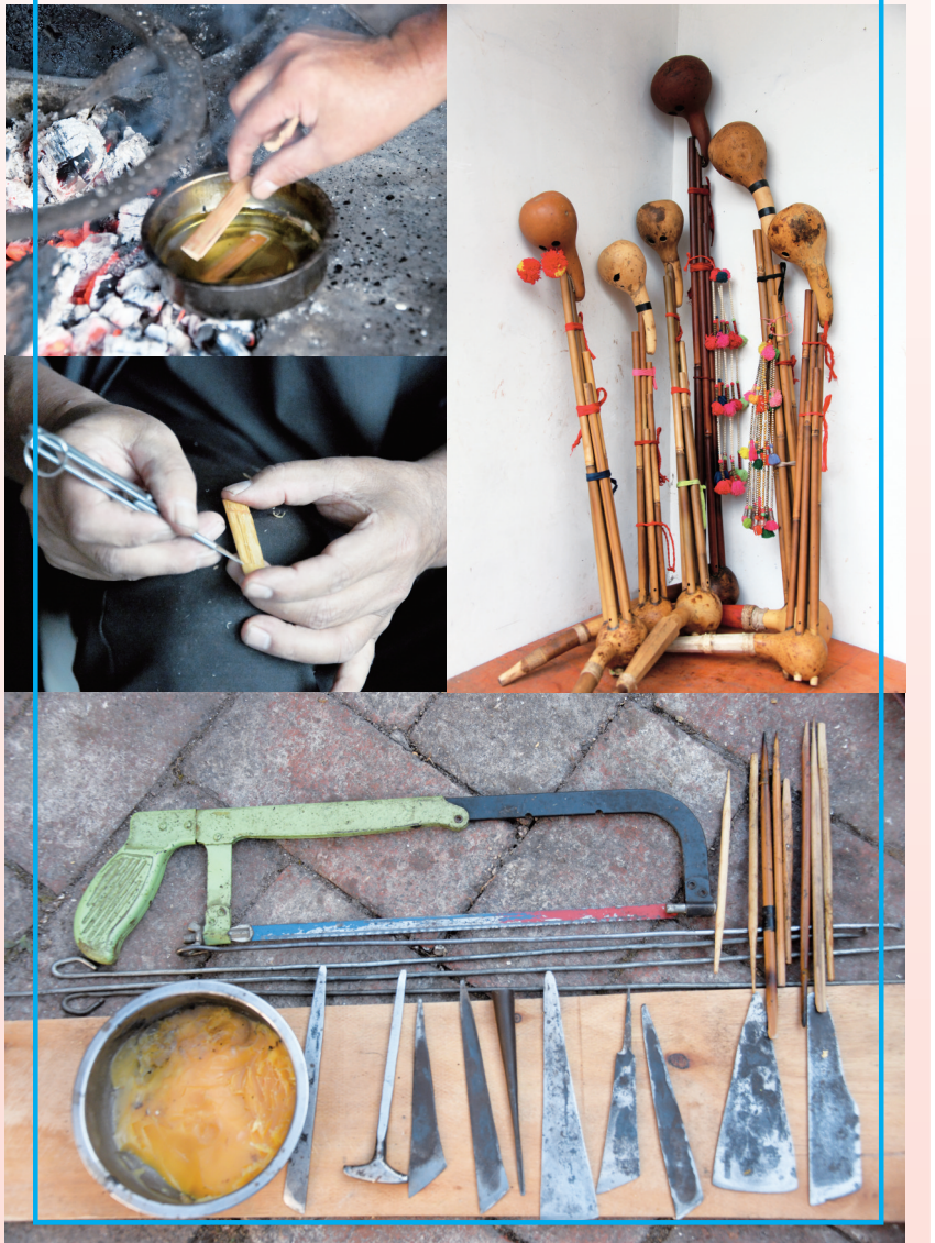
凹文光用锯片制作芦笙管(上图)、将削好的簧片放在香油中加热以增加它的韧性(小图上)、雕刻簧片(小图下)、制作的成品芦笙(直图)和制作芦笙的工具(下图)。
