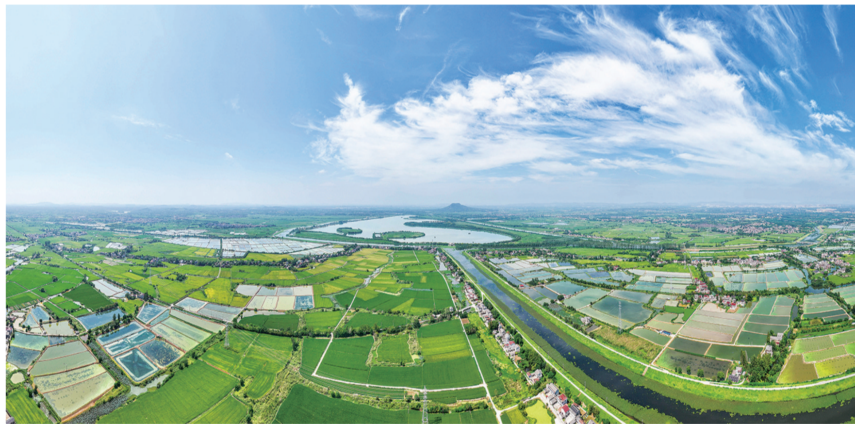
9月15日拍摄的句容赤山湖及周边农田（无人机全景照片）。江苏句容赤山湖灌排工程，至今已有1700多年历史，是目前淮河流域重要的灌排与防洪调蓄工程，灌溉面积达7.7万亩。该工程在平原圩区通过筑塘成湖、双重蓄水和双向水闸调控，有效缓解了低洼地区易涝旱问题。近年来，句容市统筹做好赤山湖保护与利用，相继完成赤山红砂岩口关闭、化工污染企业关停搬迁以及赤山湖、赤山景观提升改造等大量基础性工作，修复万亩湿地并完善水利设施。
