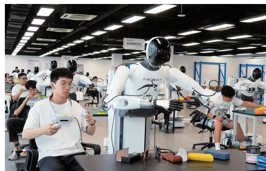
9月23日,工作人员操作机器人进行不同场景作业的数据采集。为探索具身智能机器人在工业场景中的应用,位于浙江绍兴上虞区的杭州湾具身智能创新中心根据真实作业流程搭建数据采集场景,开展机器人作业模型训练,为具身智能机器人进入真实生产线积累实操经验。
