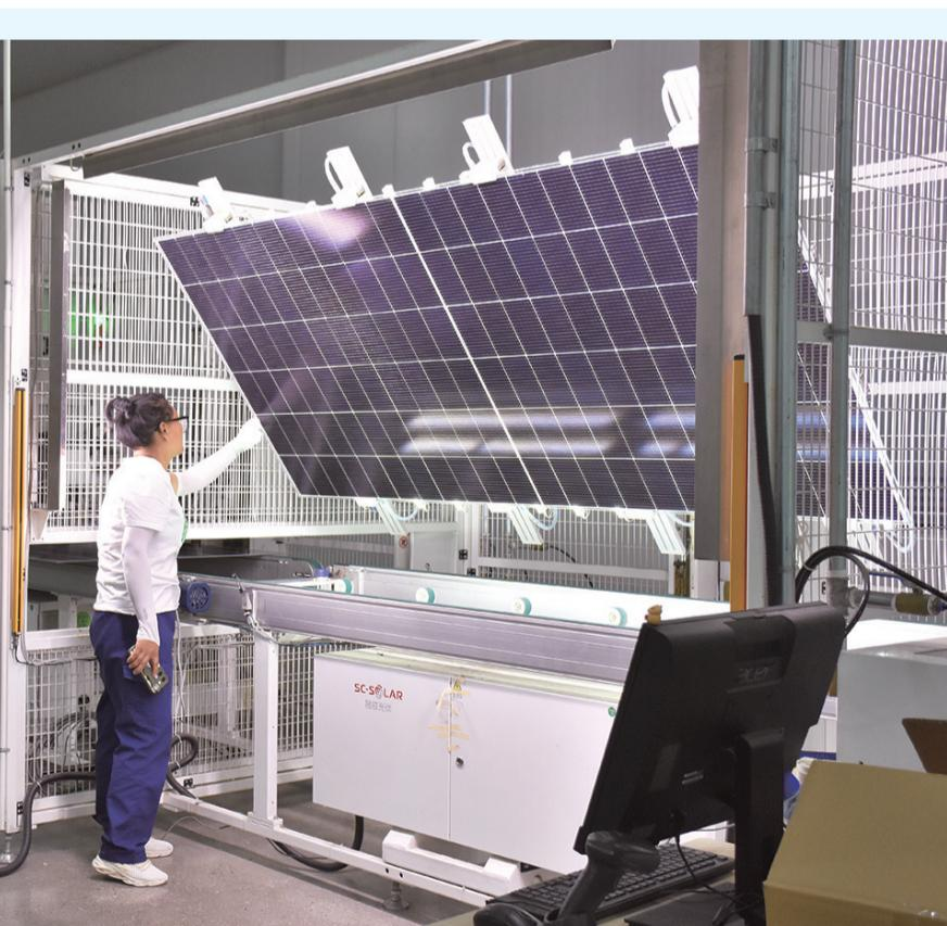
在位于大理上登先进装备制造产业园的大理英利新能源有限公司组件生产车间内，工作人员正在对太阳能电池板组件进行外观检查。
