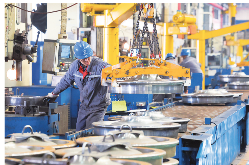
1月8日, 工人在中车石家庄车辆有限公司生产火车轮对。
