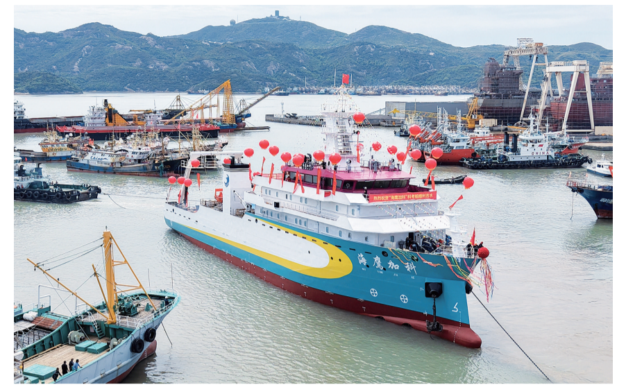
下水后的“海鹰加科”号科考船(5月5日摄,无人机照片)。5月5日,中国首艘民营建造科考船“海鹰加科”号在浙江温岭市松门镇建成下水。这艘由民间资本投资约1.5亿元建造的科考船总长82米,计划满载排水量3500吨,续航力1万海里,自持力大于60天,具备在无限航区执行多学科综合考察的能力。它的投资者是37位浙江温岭渔民。2025年3月17日,“海鹰加科”号科考船正式开工建设。建成后,计划通过租赁方式服务高校、科研院所等机构。【新华社记者 黄宗治 摄】
