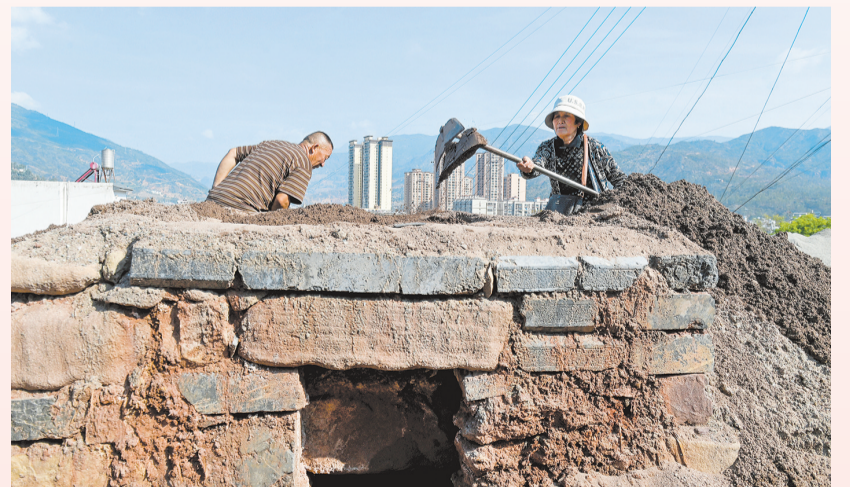
碱田灌水后形成的碱沙送入滤台过滤。
