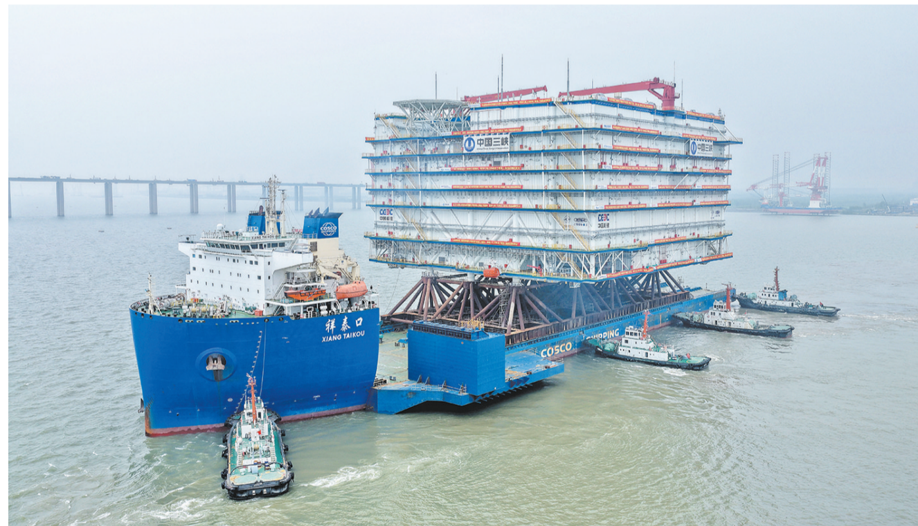
5月27日,总重约2.5万吨的超大规格海上换流站“海风之心”在江苏南通振华重工正式发运,将运往广东阳江海上风电场(无人机照片)。 【新华社发(许丛军 摄)】
