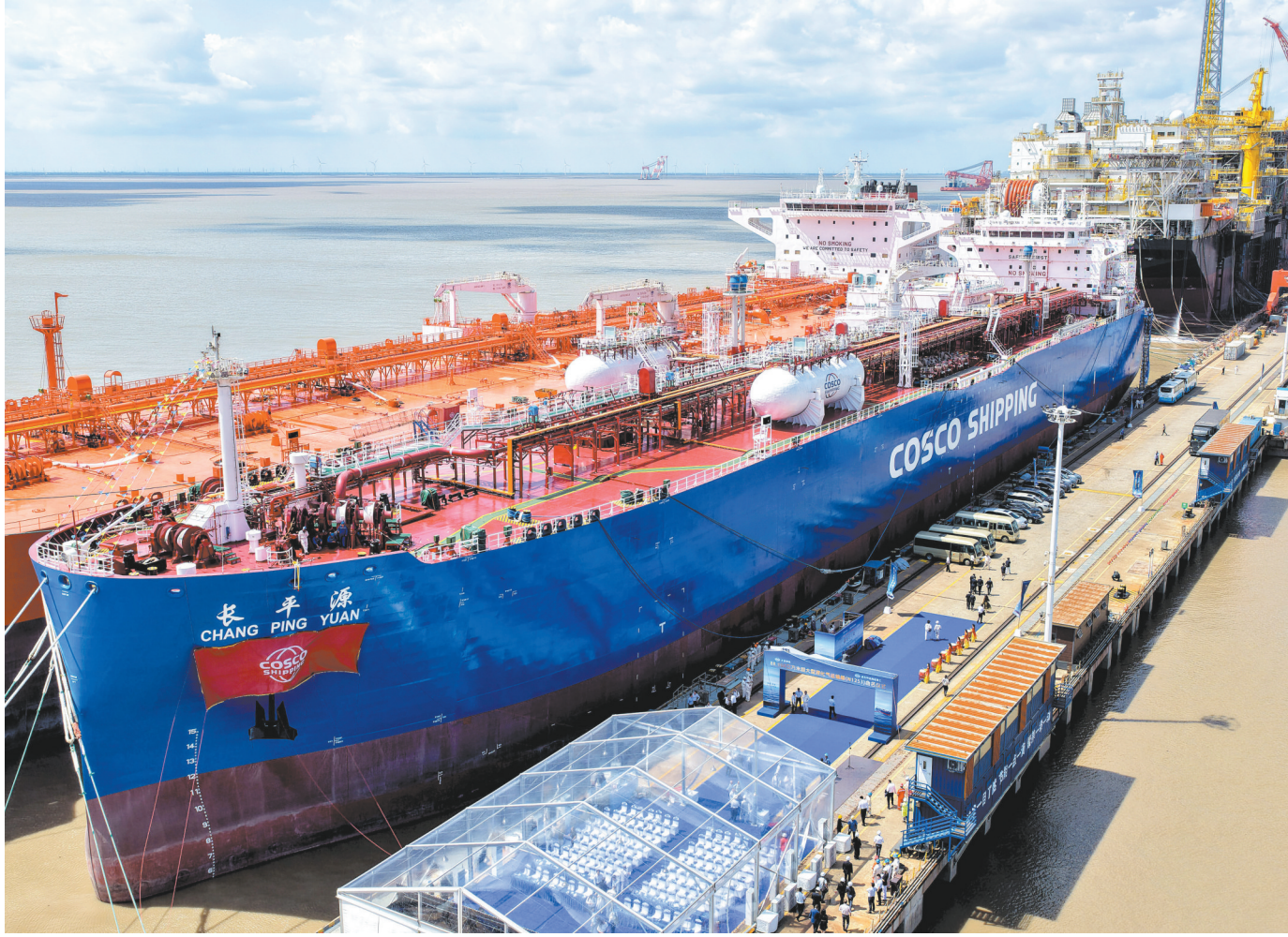
9月8日在江苏启东中远海运工码头拍摄的“长平源”轮(无人机照片)。 9月8日，由我国自主设计建造的88000立方米超大型液化气运输船“长平源”轮在江苏启东中远海运工码头命名交付。该船总长约230米，型深23.85米，配备4个A型独立液货舱，具备多品类运输能力，可运输LPG、液氨等9种液化气体货种，助力清洁能源高效可靠运输。 【新华社发（许丛军 摄）】
