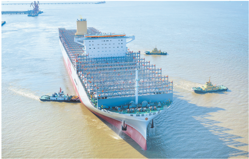
9月10日，由我国自主研发设计建造的2.4万标箱超大型甲醇双燃料集装箱船“东方优雅”轮出海试航(无人机照片)。 9月10日，在位于江苏省南通市崇川区的南通中远海运川崎新船装基地，由我国自主研发设计建造的2.4万标箱超大型甲醇双燃料集装箱船“东方优雅”轮出海试航。 “东方优雅”轮总长399.99米，型宽61.3米，型深33.2米，最大载箱量24168标准箱，载重吨22.5万吨，可切换甲醇与传统燃油模式。使用绿色甲醇时，单船每年可减少二氧化碳排放约15万吨。 【新华社发（许丛军 摄）】
