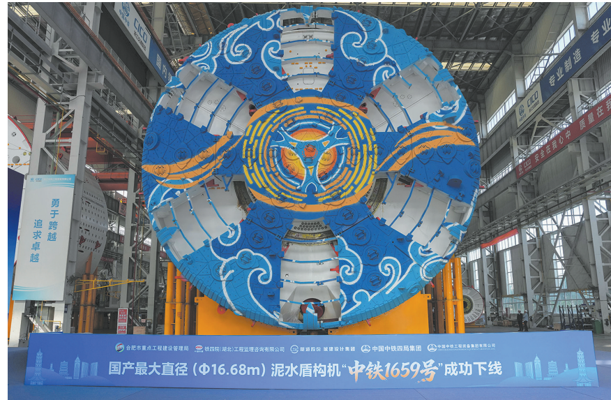
10月22日，盾构机“中铁1659号”在杭州完成总装下线。10月22日，由中铁四局联合中铁隧道局、中铁装备共同研制的超大直径泥水平衡盾构机“中铁1659号”在浙江杭州完成总装下线，即将投入安徽合肥G4001连接线1标（北二环西延）项目建设。“中铁1659号”开挖直径16.68米，整机长度约125米，标志着我国超大直径泥水平衡盾构装备实现关键技术突破。【新华社记者 黄宗治 摄】
